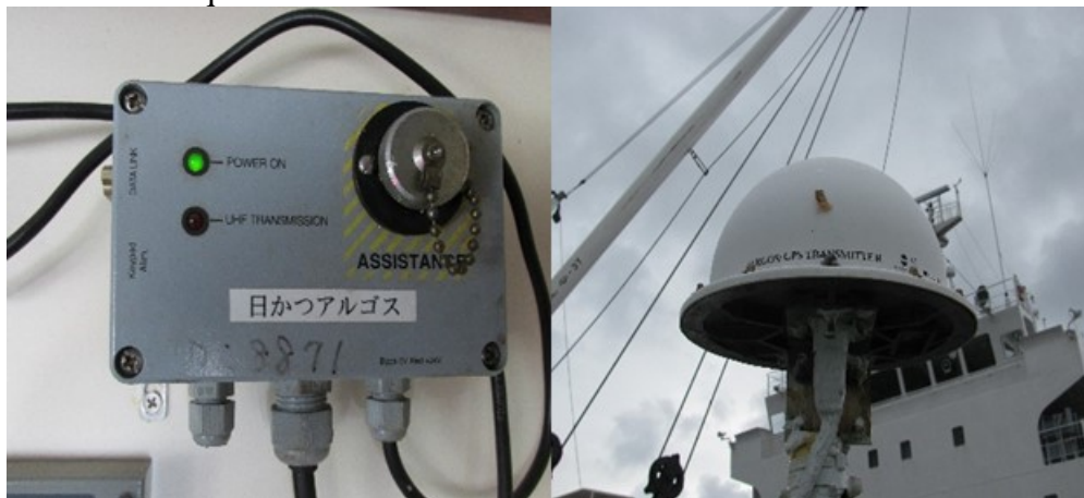
Figura 16. Dispositivo Argos MARGE con el interruptor de corriente encendido y su antena correspondiente.
