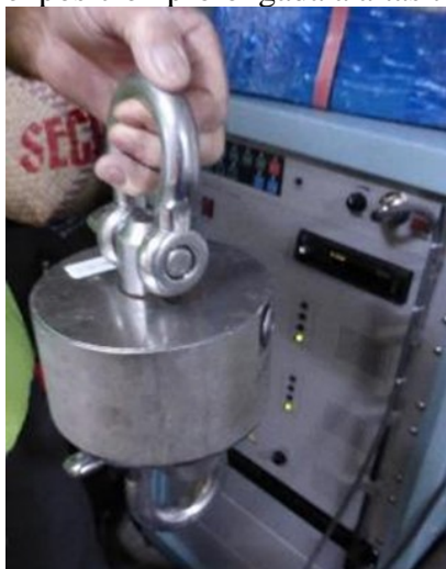
Figura 7. Báscula de gancho con transmisión por Bluetooth.
