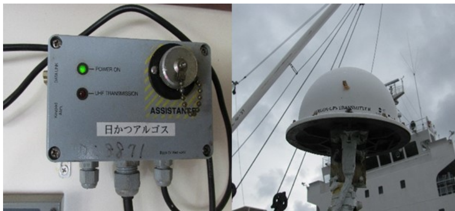
Figure 16. Unité Argos MARGE avec voyant d'alimentation allumé et antenne correspondante.
