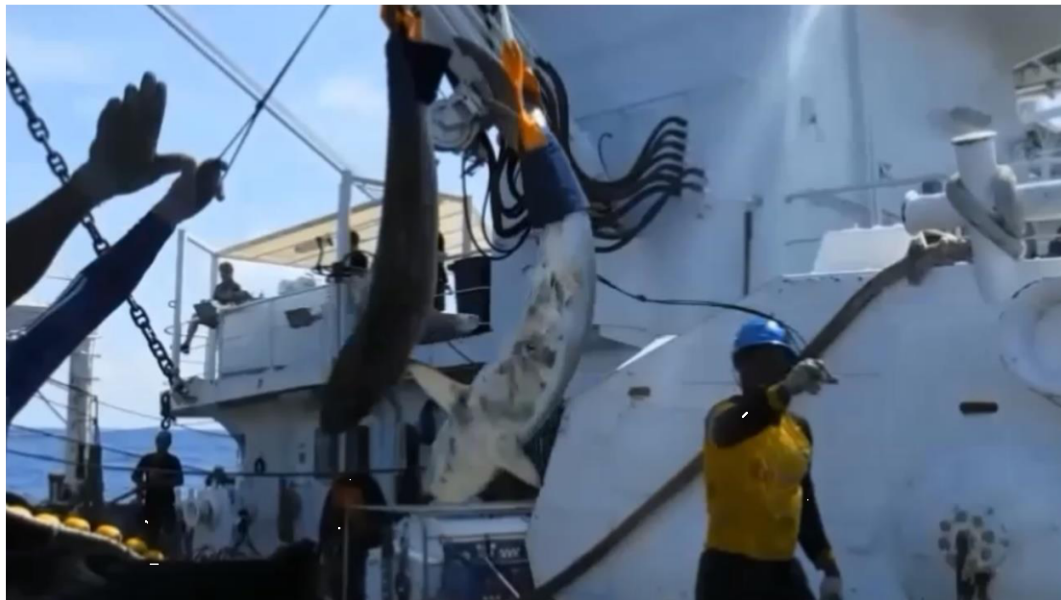
Figura 6. Detalle del chicote amarrado a las gazas del velcro. Dos tiburones transportados por la grúa hacia estribor para liberación. El chicote que sujetan los marineros es relativamente corto lo que aumenta el riesgo de caída de pesos suspendidos e incluso de mordedura por proximidad.
