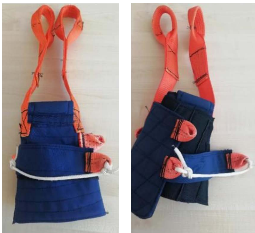
Figura 4. Velcro bien adherido (izq.) y mal adherido (dch.)
