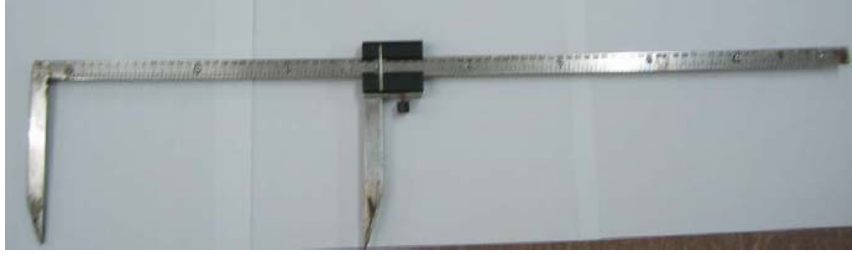
Figure 4.3.1. Exemple de pied à coulisse. Photo de Sarralde et al. (2005), reproduite avec l'autorisation de l'auteur.
