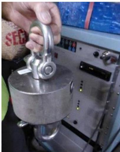
**Figura 7.** Báscula de gancho con transmisión por Bluetooth
