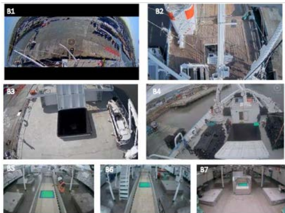
Figure 1. Exemple d'EMS avec 7 caméras (quatre sur le pont supérieur et trois sur le pont du coffre) installées sur un senneur, couvrant les principales zones de pêche et d'opérations de manipulation des poissons, y compris 1 caméra supplémentaire sur le tapis transporteur : (B1) Caméra avec vue panoramique à 360°(vue bâbord), (B2) Caméra avec vue du nid-de-pie de la poupe, (B3) Caméra avec vue de la grue du pont de travail, (B4) Caméra avec vue du pont avant, (B5) Caméra avec vue du tapis transporteur de la poupe, (B6) Caméra du milieu du tapis transporteur, et (B7) Caméra du tapis transporteur de la proue (source : Digital Observer Services).
