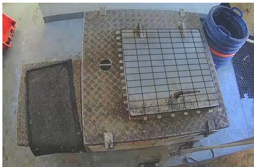
Figure 2. Exemple d'une trappe calibrée à bord d'un navire de pêche commerciale. Ces zones varieront d'un navire à l'autre, en fonction des surfaces disponibles et des espèces à mesurer. Cette image est fournie à titre d'exemple pour une pêcherie non thonière. Pour les pêcheries de thonidés et d'espèces apparentées, les zones définies devront être plus grandes pour accueillir des espèces plus grandes (source de l'image : Centre des sciences de l'environnement, des pêches et de l'aquaculture -Centre for Environment Fisheries and Aquaculture Science - CEFAS).
