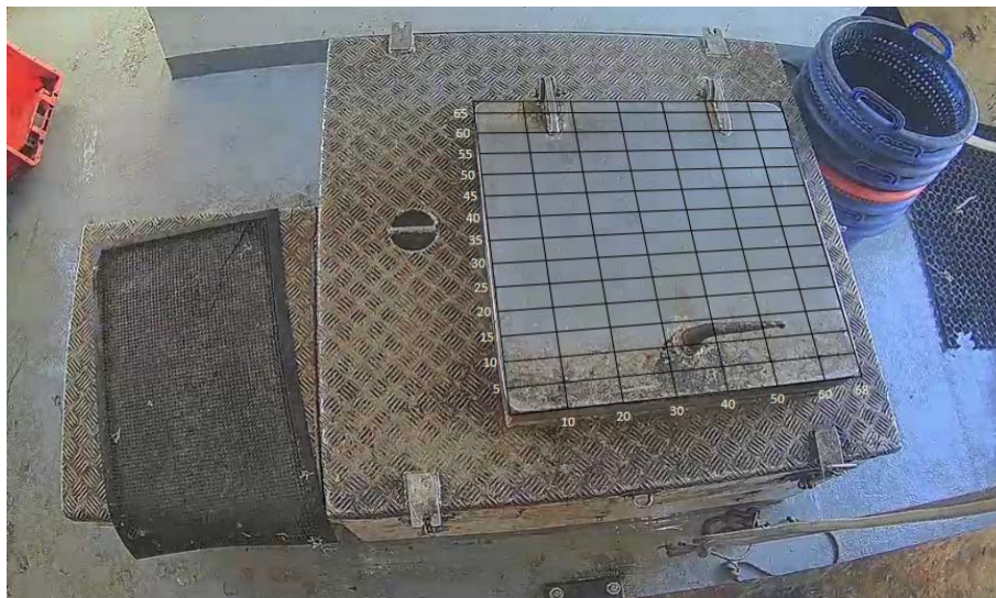
Figure 1. Exemple d'une trappe calibrée à bord d'un navire de pêche commerciale. Ces zones varieront d'un navire à l'autre, en fonction des surfaces disponibles et des espèces à mesurer. Cette image est fournie à titre d'exemple pour une pêcherie non thonière. Pour les pêcheries de thonidés et d'espèces apparentées, les zones définies devront être plus grandes pour accueillir des espèces plus grandes.
