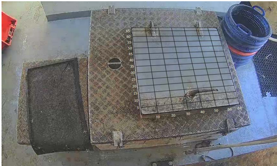
Figure. Exemple d'une trappe calibrée à bord d'un navire de pêche commerciale. Ces zones varieront d'un navire à l'autre, en fonction des surfaces disponibles et des espèces à mesurer. Cette image est fournie à titre d'exemple pour une pêcherie non thonière. Pour les pêcheries de thonidés et d'espèces apparentées, les zones définies devront être plus grandes pour accueillir des espèces plus grandes.
