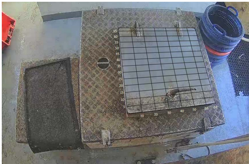
Figura 2. Ejemplo de escotilla calibrada a bordo de un buque de pesca comercial. Estas áreas variarán de un buque a otro, dependiendo de las superficies disponibles y de las especies que se midan. Esta imagen se ofrece como ejemplo de una pesquería no atunera. En el caso de las pesquerías de túnidos y especies afines, las zonas delimitadas tendrán que ser mayores para dar cabida a las especies más grandes (fuente de la imagen: Centre for Environment Fisheries and Aquaculture Science- CEFAS).
